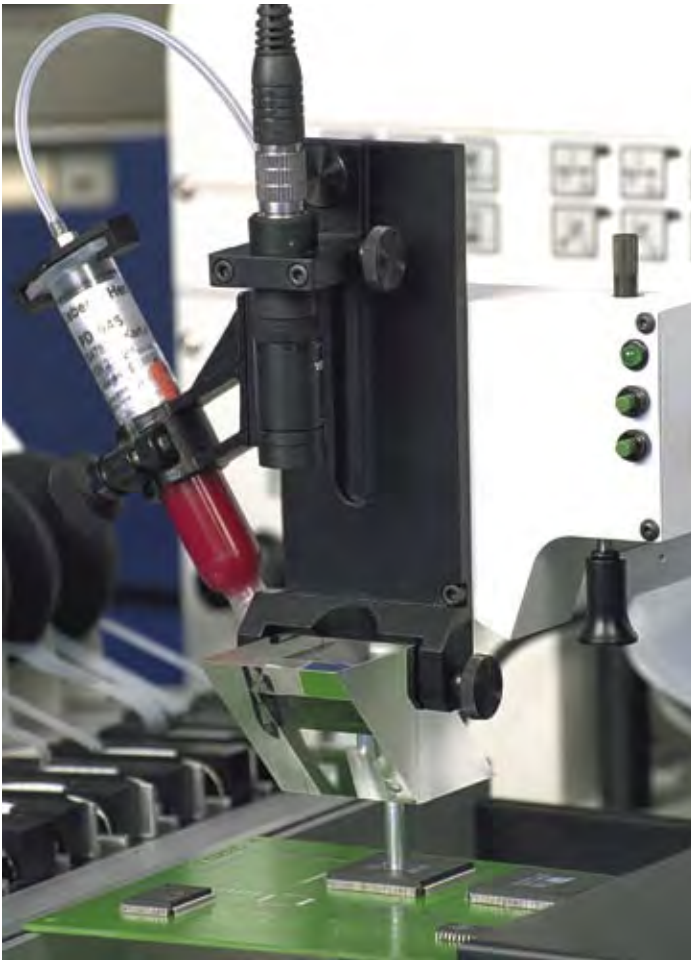
Das Bauteil wird in der Schwebe positioniert, exakt ausgerichtet und anschliessend automatisch abgesenkt.
