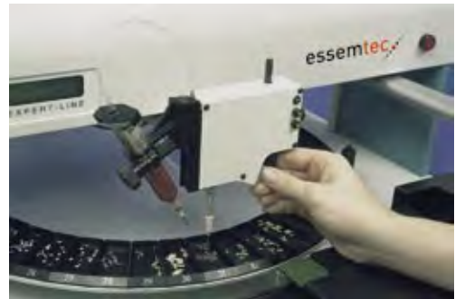
Die manuellen EXPERT-M Bestückungsgeräte werden vielfach in Prototypenfertigungen eingesetzt. Bestücken einzelner Platinen oder Nullserien mit SMD Bauteilen können schnell und präzise ausgeführt werden.
