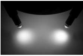
Intensitätsvergleich Photonic Faseroptik mit 80-LED-Ringlicht, jeweils bei max. Helligkeitseinstellung
