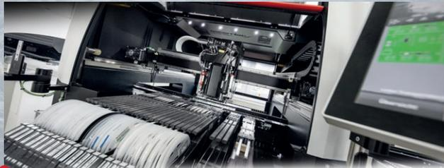
Konfigurierbare Köpfe mit 2-4 Bestückungsachsen je nach Modul. 2,5D und 3D Dosieren und Jetten. Hochauflösendes digitales Cognex Vision System mit automatischem Komponenten Teach-in und Erkennung irregulärer Kontakte.
