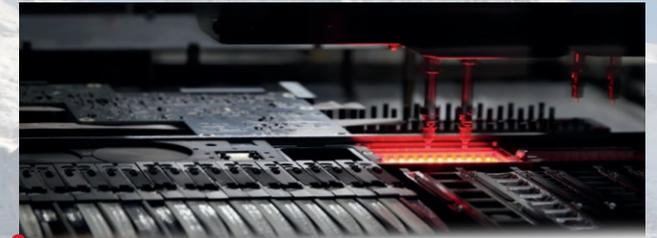
Überaus flexible intelligente Feeder, mehrspurige Kassetten oder hochpräzise einspurige Feeder. Komponenten auf Gurt, Stick, Streifen und Paletten werden verarbeitet. Grösstes Bauteilspektrum; 01005 bis 80 x 80 mm, Bauteilhöhe bis 25 mm.
