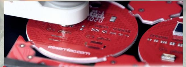
Bis zu drei Prozesse gleichzeitig, „Plug and Play“ für den Ventilwechsel. Piezo Jet Ventil – super High-Speed für geringe Viskosität. Dynamic Shockwave Lotpasten Jet Ventil, Volumen Ventil, Zeit-Druckventil, Archimedisches Schraubventil
